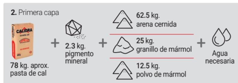
**La segunda capa.** Formada por pasta de cal hidratada, granillo de mármol y polvo de mármol.
