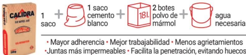
**Nota 1:** La consistencia para pisos será más líquida que la mezcla requerida para muros.
