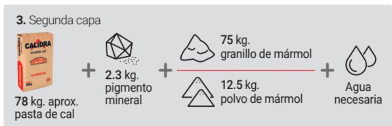
**La tercera capa.** Formada por pasta de cal hidratada y polvo de mármol. Es la capa final del recubrimiento, la que otorga la apariencia pulida al muro.
