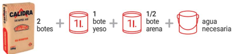
Los aplanados se hacen a plomo y regla en muros, a nivel y regla en plafones. En ambos casos se colocan maestras (guías) a una separación máxima de 2 m, las que sirven de guía para distribuir la mezcla con la ayuda de reglas de aluminio, afinándose después la superficie.
