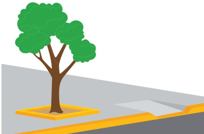
El espesor de las banquetas debe ser de 8 cm como mínimo, colocándose la malla electrosoldada a 2/3 partes del mismo.
